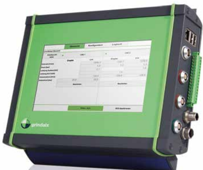
Alustyle Резистивный сенсорный экран под сплошной плёнкой.
